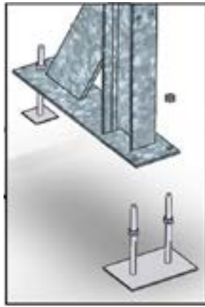
Abbildung 3 – a und b - Anbringen der Buchsen an den Streben
